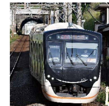
環境性能を向上させた新型車両（旧型車両の約50%の消費電力で運行）
